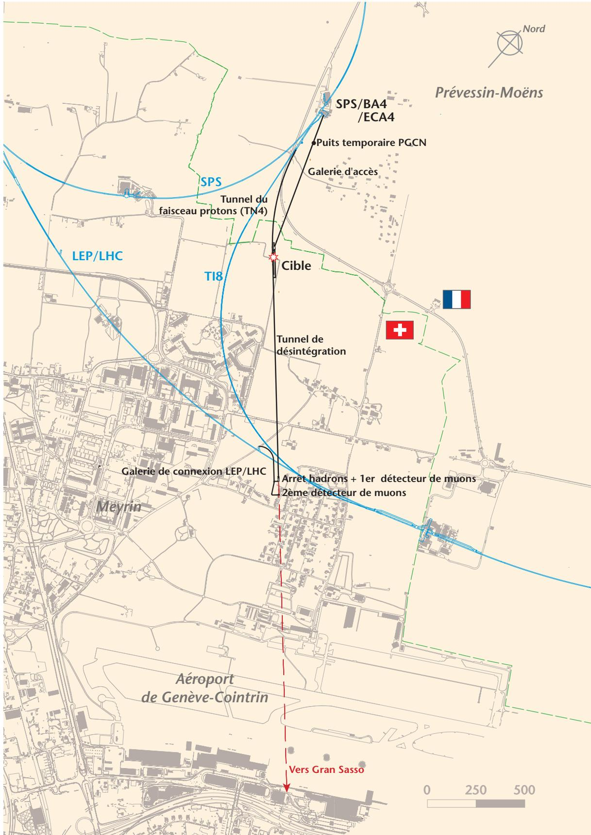
Figure 10: Plan de situation des ouvrages du projet CNGS
