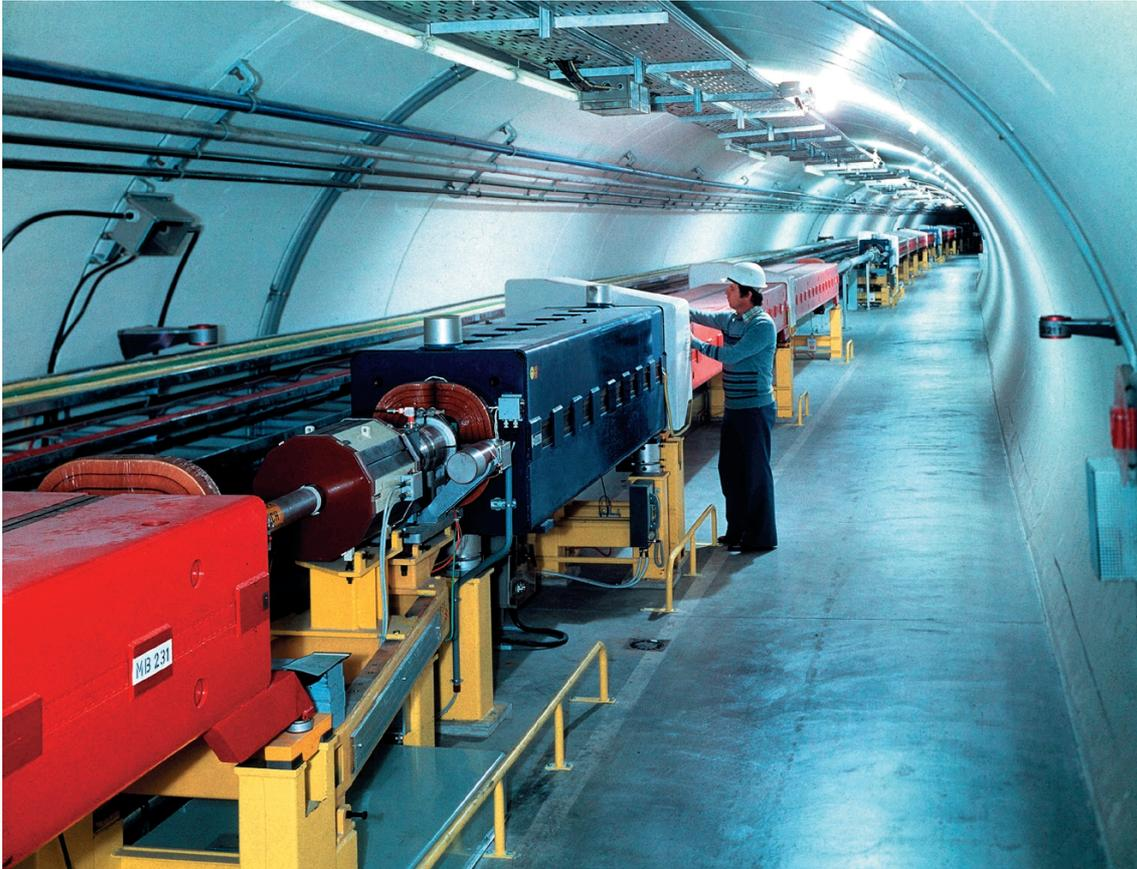
**Figure 9: Dipôles (rouges) et quadrupôles (bleus) dans le tunnel du SPS**
