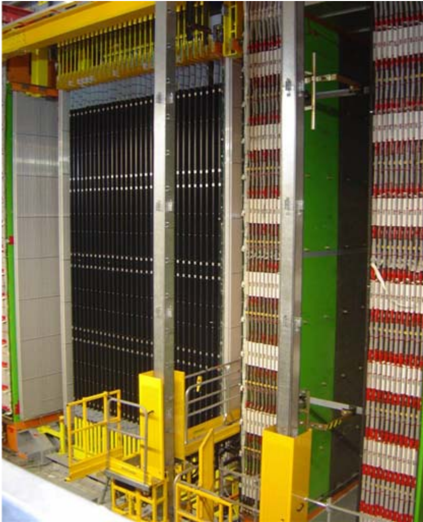
Scintillator planes 5900 m 2 8064 7m long drift tubes
